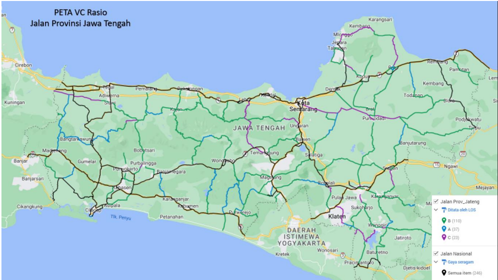
Sumber : Diolah dari DPUBMCK Prov.Jateng, 2025 Gambar II. 10 Kondisi V/C Rasio Ruas Jalan Provinsi Tahun 2024
